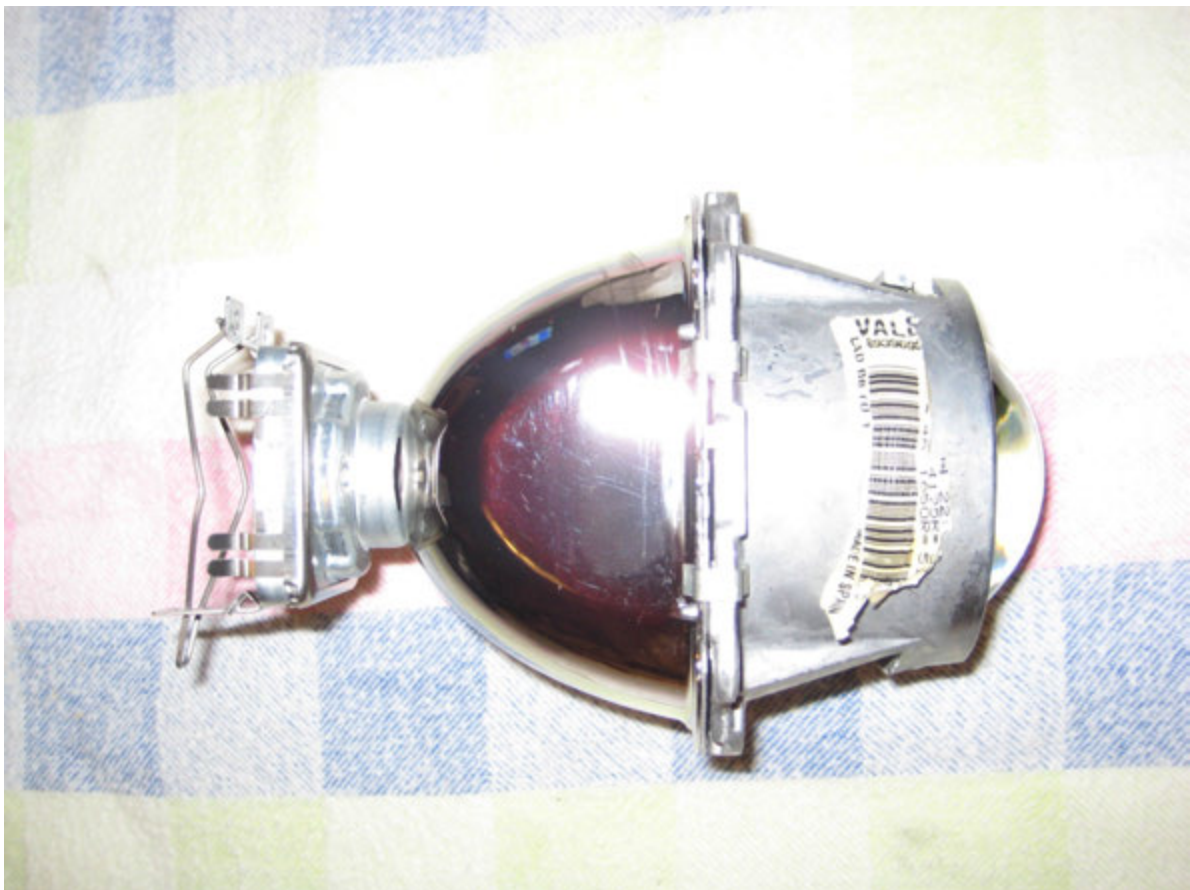
Xenoneinheit (Reflektor & Linse)
